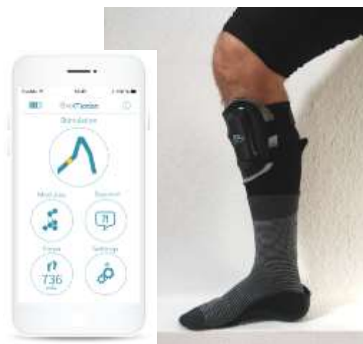
App zur Steuerung des Muskelstimulators (links), Manschette, Orthese und Muskelstimulator (rechts), www.evomotion.de
